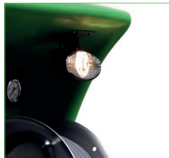
Lichtpakket voor JMB-M (optie): Werklamp en zwaailamp via joystick elektronisch in te stellen code: 1.229.240
