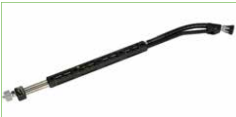
Hogedrukverlengslang met snelkoppelingen van 10 m tot 25 m en voor werkdrukken van \leq 250 bar, \leq 350 bar code: 1.208.520.xxx ( \leq 250 bar) 1.208.540.xxx ( > 250 en \leq 350 bar)
