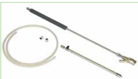
Gritstraallans van 900 mm met vlakstraal-sproeier, snelkoppeling en aanzuigbuis, geschikt voor werkdruk \leq 500 bar code: 1.258.229.15xxx
