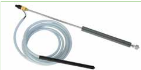
Gritstraallans van 900 mm met sproeier, snelkoppeling en aanzuigbuis, geschikt voor een werkdruk \leq 250 bar en max. 40 l/min code: 1.258.220.xxxxx
