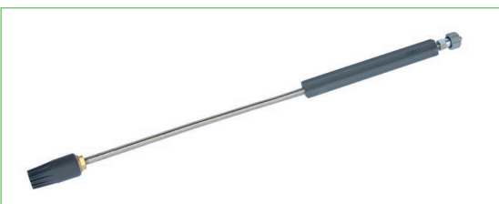
Enkele RVS lans met roterende hogedruksproeier en snelkoppeling (enkel bij \leq 320 bar en < 41 l/min) code: 1.208.729.xxxxx
